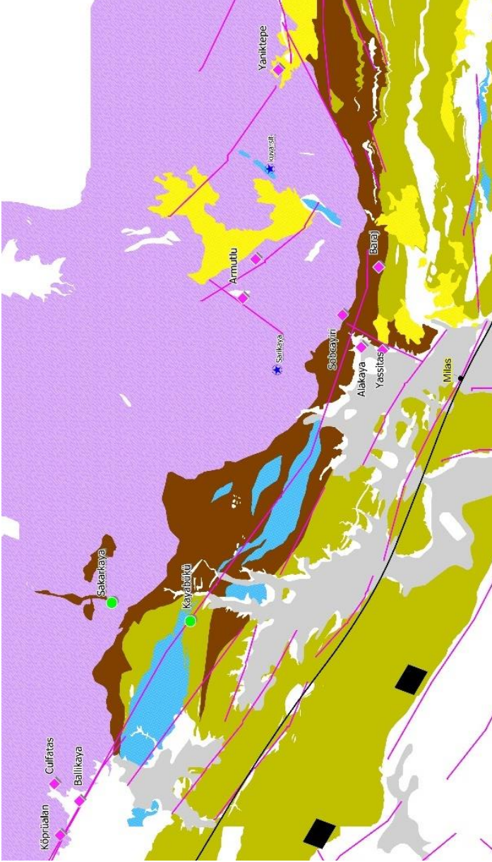
Şekil 2. Albit (feldspar) ve demir yataklarının Menderes masifi kayaçları içindeki alansal dağılımı (yataklar ve kayaç lejandı Şekil 1’de gösterildiği gibidir)
