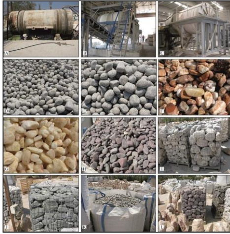
Şekil 10. Tanbur makinesi (A, B ve C), Tanburlanmış doğal taş artıkları (D-L) (Elçi vd., 2017)
