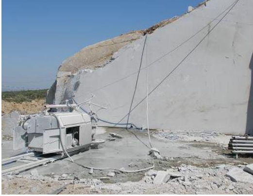
Şekil 1. Elmaslı tel mermer kesme makinesi
