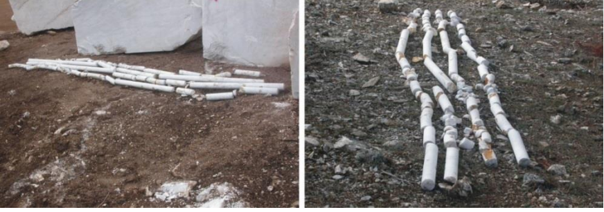
Şekil 11. Bir blok taş sahası içerisinde yapılan mekanik sondajdan elde edilen, loglanmadan ve sandıklanmadan terk edilmiş karot numuneleri (Muğla).
