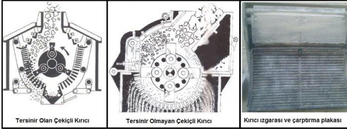
Şekil 27. Tersinir ve Tersinir olmayan çekiçli kırıcı ve çekiçli kırıcının ızgarası
