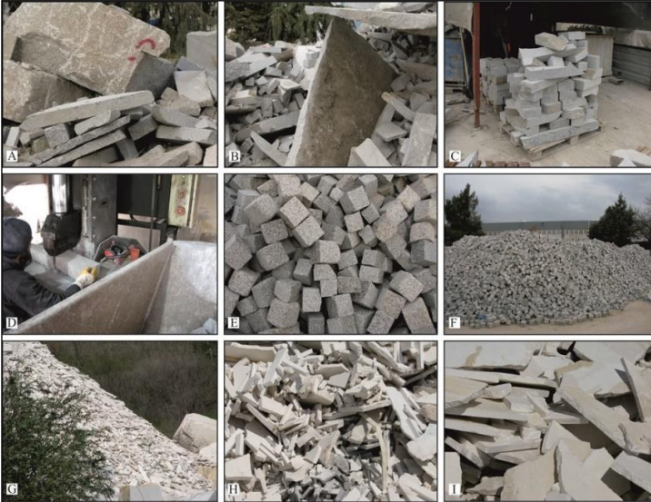
Şekil 9. Sert taş artıklarının parke taşı (A-F) ve paledyen (G-I) olarak değerlendirilmeleri (Elçi vd., 2017)
