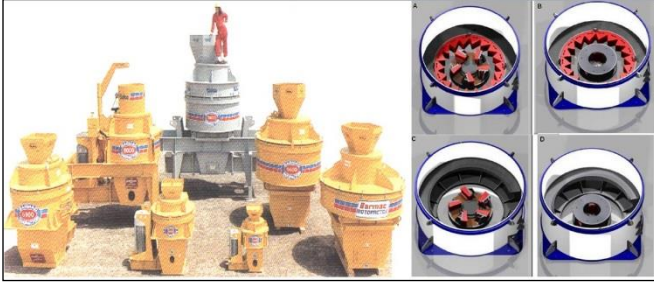
Şekil 26. Dik milli kırıcılar ve 4 farklı rotor tipi
