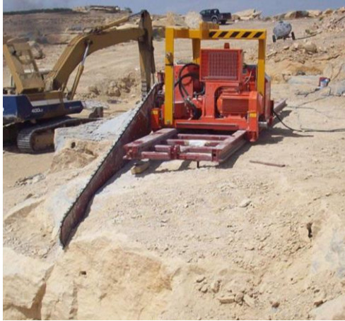
Şekil 2. Zincirli kollu mermer kesme makinesi
