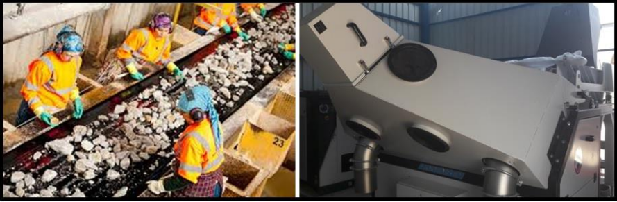
Şekil 5. Elle ve otomatik (optik) ayıklama işlemi
