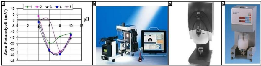
Şekil 21. Yüzey yükü ölçümleri(a), temas ölçüm(b) renk ölçüm(c) ve aşınma testi cihazları (d)
