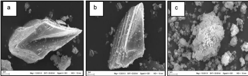
Şekil 5. Öğütülmemiş mermer tozu-silis tozu karışımında (a) kuvars ile (b) kalsit tanesinin ve (c) aşırı öğütülmüş mermer tozu-kuvars kumu karışımının SEM görüntüleri.
